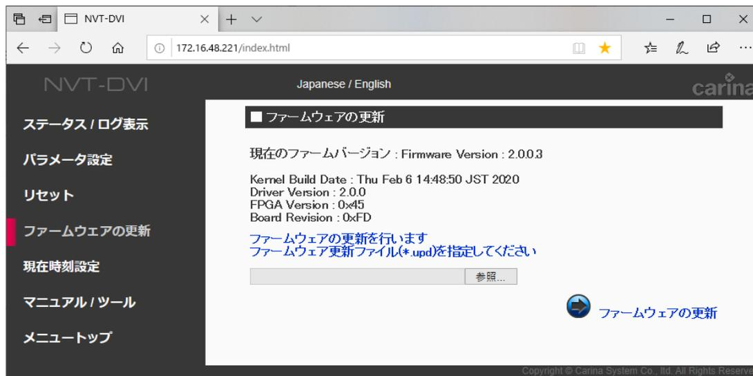
ファームウェアのバージョンや、ドライバ、FPGA のバージョン等を表示します。
