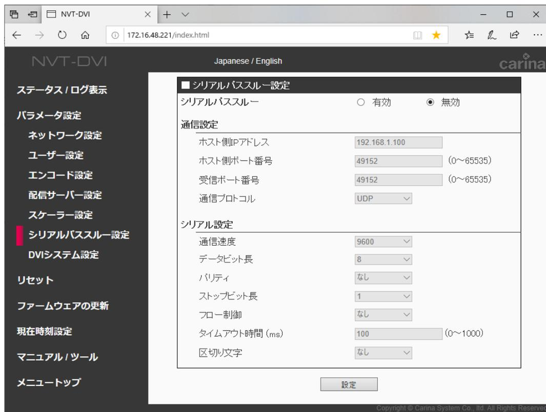
カメラコントローラなどの制御用信号を NVT の USB 端子から出力することができます。
