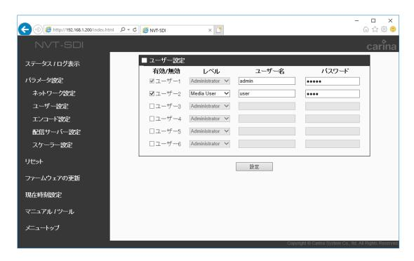
本機にアクセスするためのユーザー名 / パスワードが設定できます。 WEB コンソールのユーザーID / パスワードは、ユーザー1 に設定された値のみを使用します。
